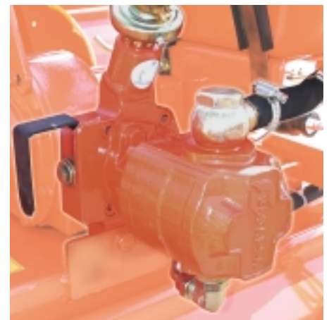
Pompa idraulica e particolare dispositivo per il disinnesto Hydraulic pump and detail of uncoupling device Pompe hydraulique et dispositif particulier pour le déclenchement Hydraulische Pumpe und besondere Auskuppelvorrichtung Bomba hidraulica y dispositivo para desembrague
