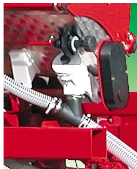
Централизованная регулировка дозатора удобрения MINIMAX Regulacja centralna dozownika nawozu MINIMAX Централізованє регулюваннє дозатора добрив MINIMAX ("МИНИМАКС") Централізовано регуліранє на торовия дозатор MINIMAX Centralized setting fertilizer doser MINIMAX
