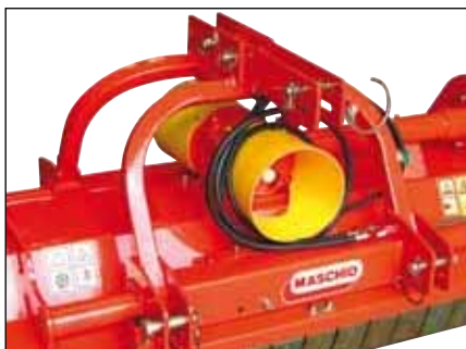
Attacco Universale a 3 punti reversibile e spostabile e Gruppo Rinvio ant./post., 540 giri con doppia ruota libera incorporata
