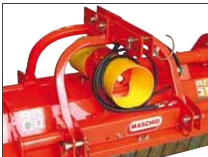
Attacco Universale a 3 punti reversibile e spostabile e Gruppo Rinvio ant./post., 1000 giri
